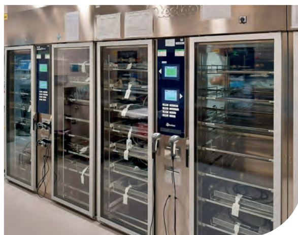
Un endoscope est scanné avant d'être déposé dans une armoire de désinfection En haut à gauche, un écran permet de suivre chaque endoscope en temps réel
